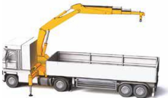
Grue de chargement montée derrière la cabine
