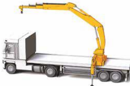
Grue de chargement montée en position centrale
